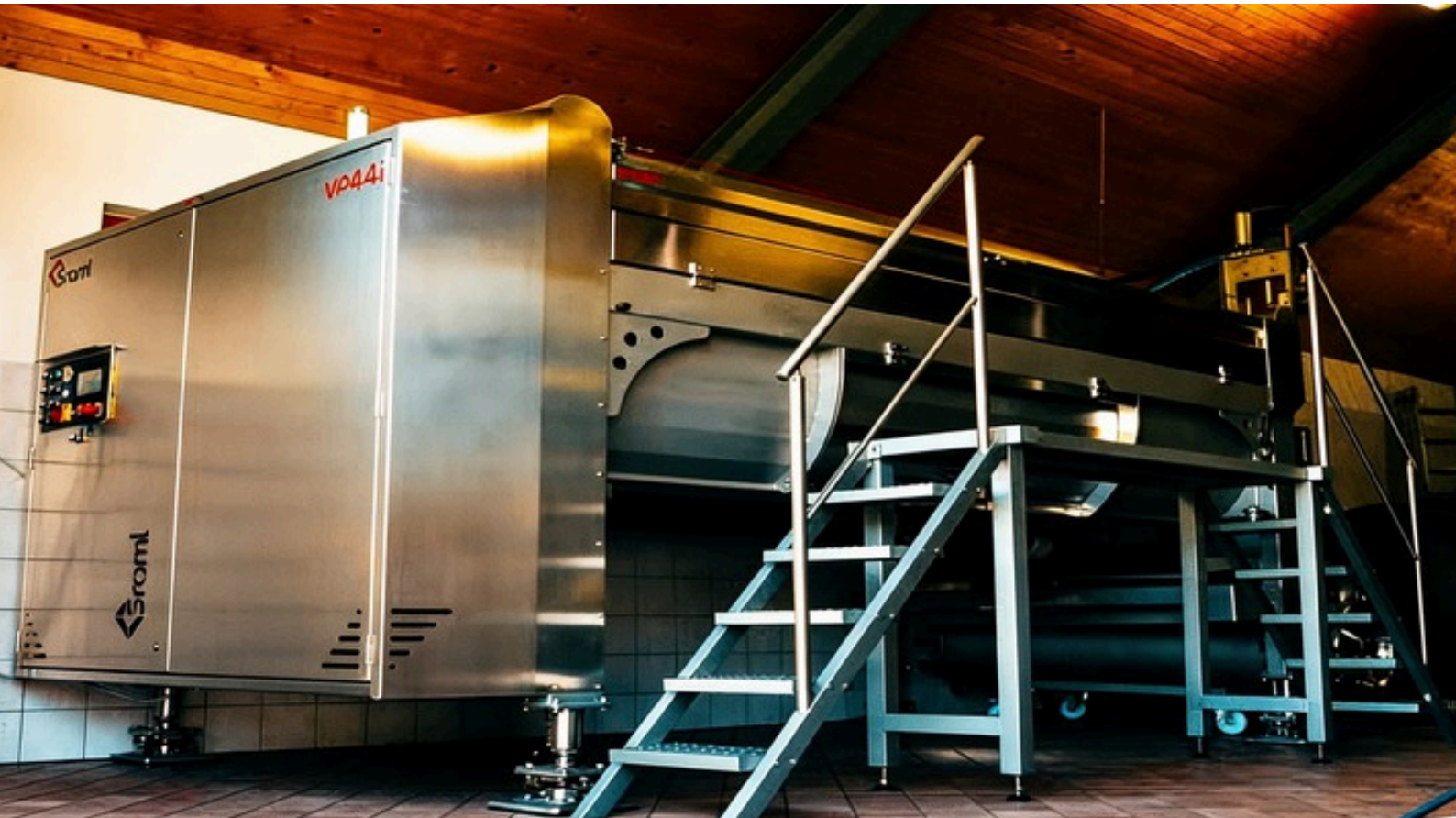
Máquina de prensado utilizada para la extracción del mosto a partir de las uvas durante el proceso de elaboración del vino.
